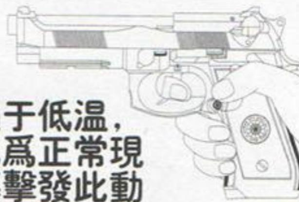
■長時間連續發射容易使彈匣過于低溫，影響氣體壓力及子彈初速，此為正常現象非故障所致。擊發時請勿倒轉擊發此動作無法使氣體揮發產生霧氣噴出容易導致零件耗損。
