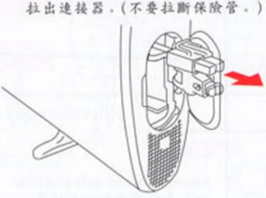
**Battery** connection 電池連接器
