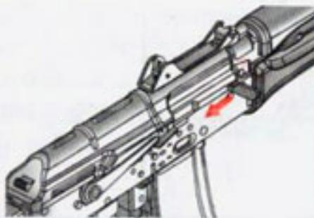
拉動槍機拉柄可將整個槍機座往後拉動。
