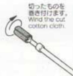
綿製品の端切れを図の大きさに切り、クリーニンググロッドの穴にはさみ込みます。(綿の厚さにより長さをかえてください。パレルにスムーズに入ればよいでしょう。)
