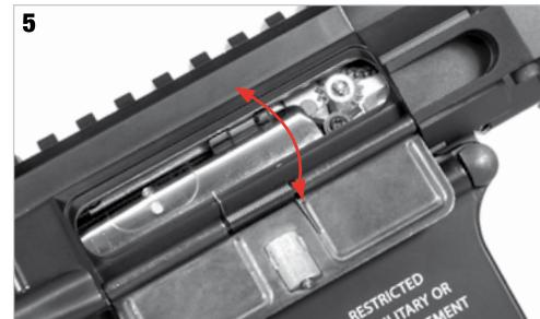
Regolare l'hop up tramite **l'apposita ghiera** ruotando **verso il basso** per aumentarne l'effetto e **verso l'alto** per diminuirlo.
