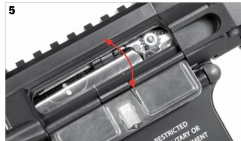
Ajustar el Hop Up mediante **su anillo girando hacia abajo** para aumentar el efecto y **hacia arriba** para disminuir.
