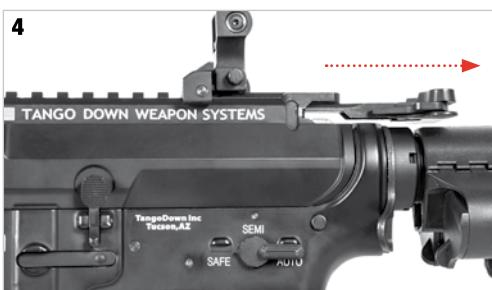
Para **ajustar** el Hop Up **tirar la palanca de montar** para **bloquear** el cerrojo.
