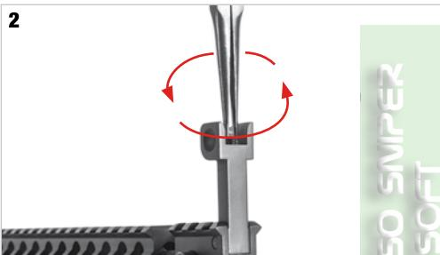
Per collimare il mirino anteriore con il punto d'impatto **ruotarlo in senso antiorario** per alzare il mirino e in **senso orario** per abbassarlo.
