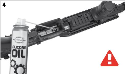
**Ogni 5.000 colpi o una volta al mese** spruzzare all'interno della camera dell'Hop Up una **piccola quantità di olio al silicone**.
