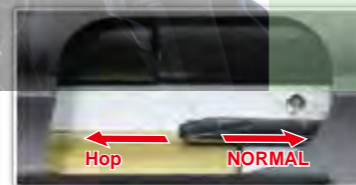
Glissez en avant ou en arrière le cran de réglage pour ajuster le hop-up.
