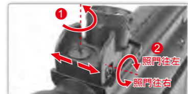
鬆開底座螺絲後使用螺絲起子調整照門風偏。
