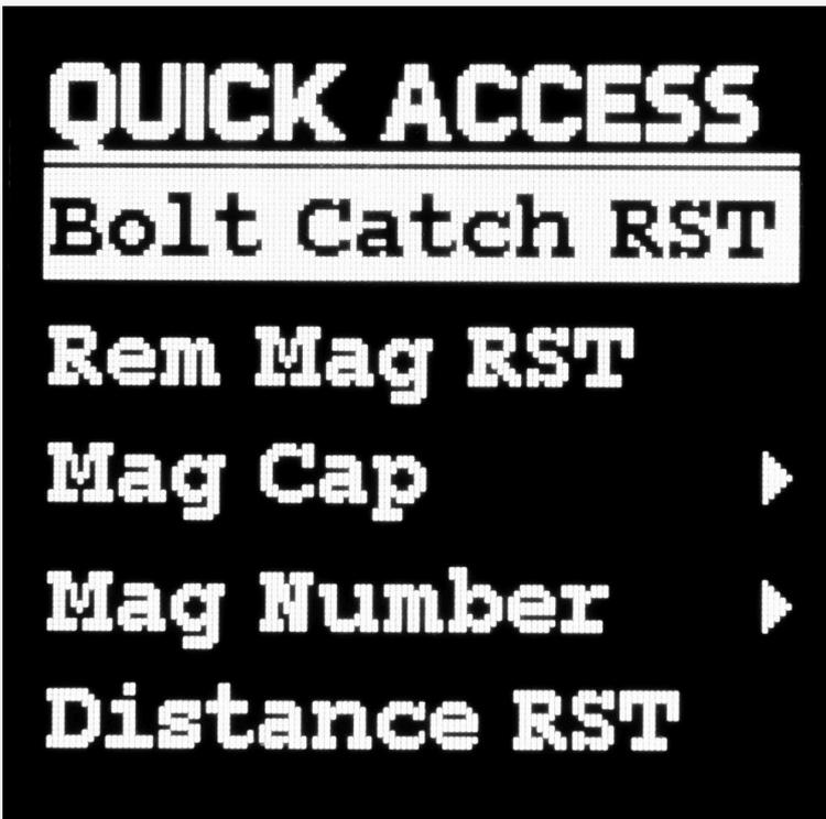
Todos los elementos con una flecha apuntando hacia la derecha > (p. ej. **QUICK ACCESS > Main Menu > System > Temp Unit > 'C, 'F, Back**) son submenús a los que se puede acceder más allá y revelan más elementos para elegir.
