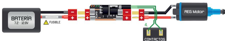
FIG 3. MONTAJE CON CAMBIO DE INSTALACIÓN (CABLEADO)
