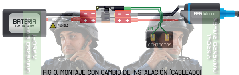
FIG 3. MONTAJE CON CAMBIO DE INSTALACIÓN (CABLEADO)
