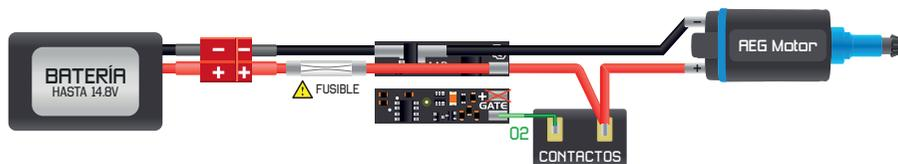
FIG 2. MONTAJE SIN CAMBIO DE INSTALACIÓN (CABLEADO)
