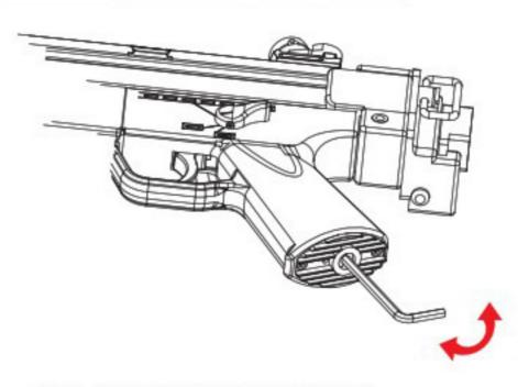
用六角板手調整馬達間隙螺絲 (出廠時已調整好)
