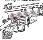
※操作前請先確保槍管內無BB彈,並切至保險模式 使用工具將止逆爪連桿向前推,將彈簧壓力釋放, 可延長彈簧壽命,避免長期擠壓造成疲乏。
