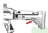
按壓槍托調整壓板即可前後調整拖塊
