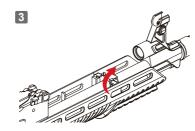
將下護木環固定鈕向上扳起。 Flip up the lower handguard fixing lever.
