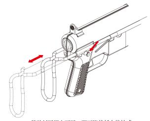
將槍托壓桿向下壓,即可將後托向後拉或 向前推,共有2段可調整
