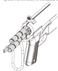
4 塞入二顆裝電池到底部,並保持電源 接頭與電池接頭皆爲外露
