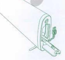
F.拉出電線。 Pull out the connector.
