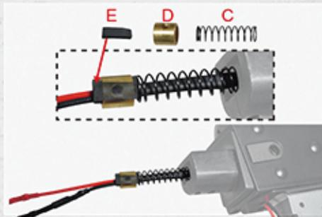
3. 依序將C、D組裝至線組上再將E組裝至D內。此裝置可避免線組再折疊時被托桿壓夾傷。
