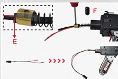
4. 以F固定E後，組裝線組。E的作用在於防止螺絲固定時讓線組受損。
