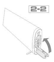
H.將電池與電線定位好,再蓋 上槍托底板蓋。 Place the connector in place
