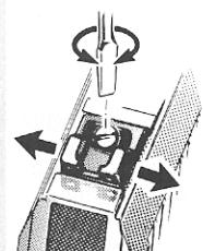
スクリューをゆるめて横にずらして調整し、しっかりと締めこむ
