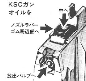
バルブプレートを押した状態で放出口（＝ノズルラバー）からマガジン内部へKSCガンオイルを注入してください。また、ノズルラバー上面部や、バルブプレートへも注油してください。
