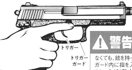
トリガーフィンガー（引金を引く指）をトリガーガードの外へ出しておく
