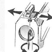
フロントで粗調整ののちリアで微調整すると合理的
