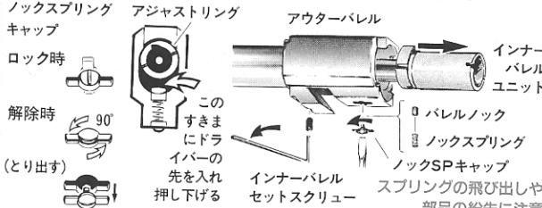
インナーバレルクリップとEリングをはずし、アジャストリングを前方へずらします。ラバーチェンバーは後方へ、ラchettringは上へはずしてください。最後にインナーバレルOリングとアジャストリングを取りれば終了です。
