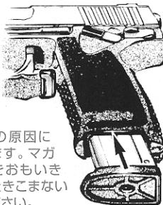
マガジンを銃本体に戻します。この時、マガジンリリースがカチンと音をたててかかるのを確認し、念のため一度マガジンを下に引いて抜け落ちないことを確かめてください。
