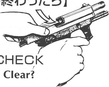
マガジンを抜き、スライドを引いてチャンバー内に残弾がないことを確認してください。残弾がある場合、スライドリリースをかけた状態で、銃口側からロッド状のものを利用して押し出してください。
