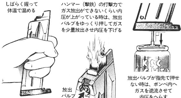
\*寒冷期は気化が遅く圧力も低いため、夏場より液状ガスが多く注入され気化スペースを狭くし、最初の数発は生ガスがでてしまう傾向が強まります。満タン注入後はガスを少量放出し、気化スペースを作ってください
