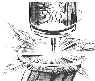
3. 正常な注入後、満タンになったら液状ガスが吹き出しますので注入を終了してください。しばらく放置しまガジンが常温（触ってみて熱さや冷たさを感じない程度）に戻ってから使用します。（マガジンが冷えていると正常に作動しません。）
