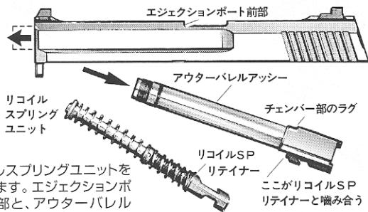
リコイルスプリングユニットをはずします。エジェクションポート前部と、アウターバレルのチャンバー部のラグが噛み合っていないようにし、そのまま前後にスライドを動かしてピストンとの連係をはすし、斜め下後方に抜いてください。
