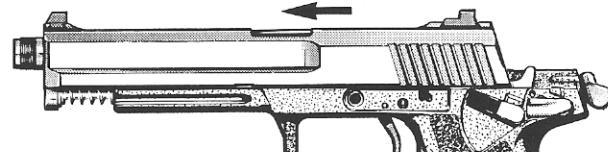
スライド左側面中央底部の切り欠きをスライドリリースレバー軸部に合わせると、レバーの爪部が見えます。この状態で逆側からレバーのシャフトを押せばスライドリリースレバーが左側にはすせます。次にスライドアッサーを前方に引き抜いてください。
