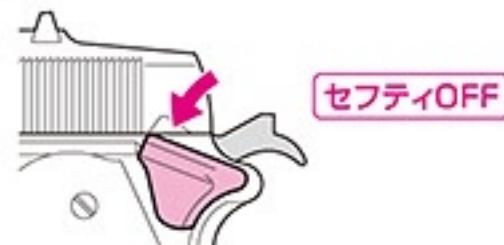
サムセフティをセフティONにしている間は、トリガーとスライドが作動しなくなります。破損の原因となりますので、セフティOFFにするまで、トリガーやスライドを引かないでください。
