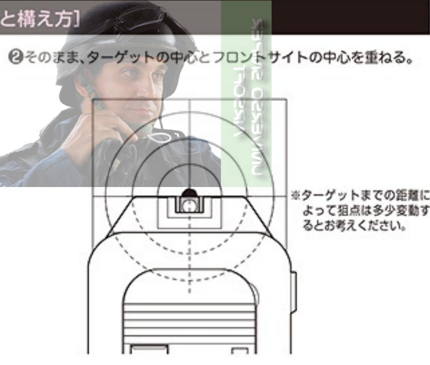
※ターゲットまでの距離が近いと、下図の通りにサイティングしても狙いより下に着弾します。この製品の特性上、フロント / リアサイトに着弾点の調節機能はありませんので、着弾点が下がっている場合はターゲットの上を狙うようにしてください。
