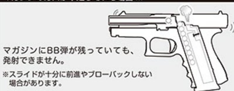
マガジンを外してガスを注入し、残弾を全て発射する。
