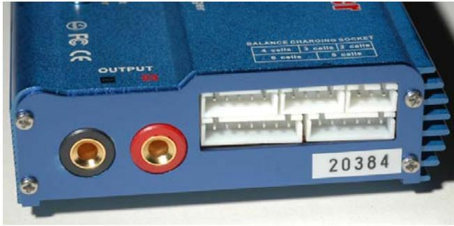
Esta función es para equilibrar el voltaje, de las baterías de polímero de litio, durante el proceso de carga. En la modalidad balanceado, la batería debe tener un cable de balanceado, para conectarlo al zócalo correspondiente al lado derecho del cargador. Y también es necesario conectar el enchufe de salida de la batería, a la salida de carga (Rojo y negro) del cargador.
