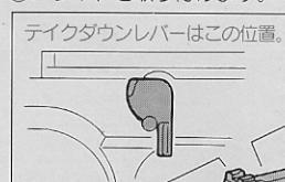
⑤テイクダウンレバーを回してバレルを固定し、マガジンをセットして完成です。
