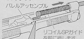
**ポイント** リコイルSPガイドのツメが見えるまで前に押し、バ렐アッセンブルを避けて取り出します。
