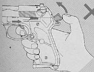
● ガス切れやマガジンの温度低下又は気温の低い冬季などの場合は、ガス圧が低下し、スライド・ストップがかからない場合が出てきますが故障ではありません。ガス充電、及びマガジン温度が20°C位まで回復すれば正常に作動するようになります。
