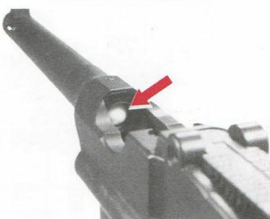
マガジンを抜いても、チャンバー内に、BB弾が残っている場合があります。抜き棒で後ろから押して、銃口から出して下さい。
