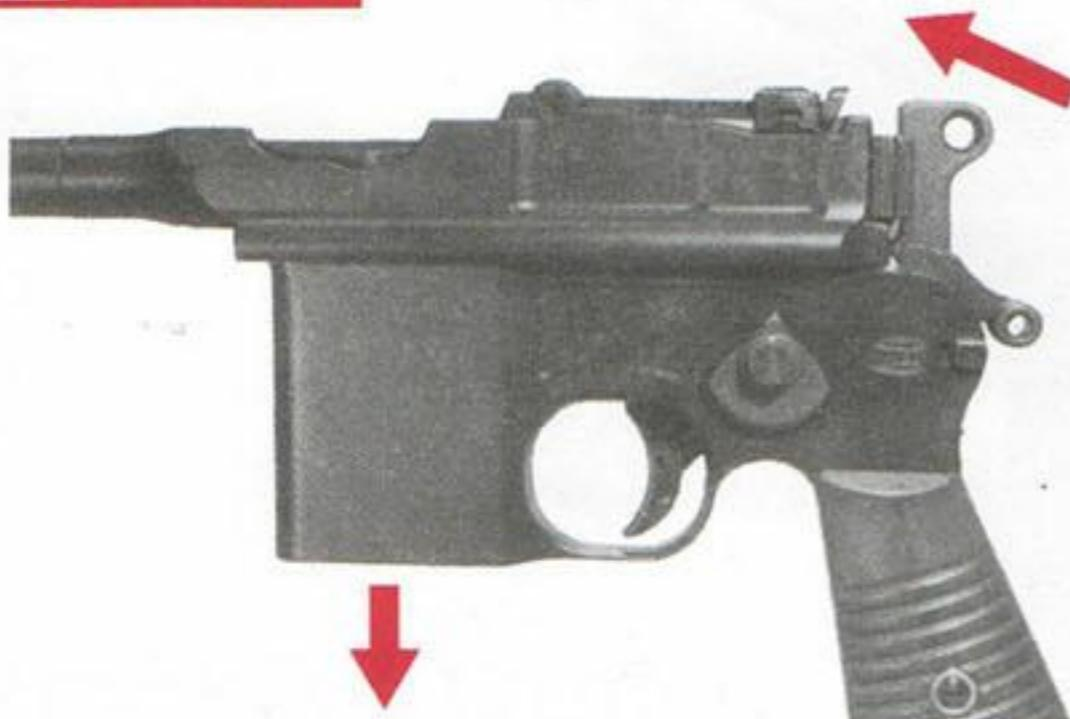
射撃後はハンマーが発射体勢なのでマガジンを抜いて、チャンバーにBB弾が無い事を確認のうえ、トリガーをひいてハンマーを待機状態にして下さい。
