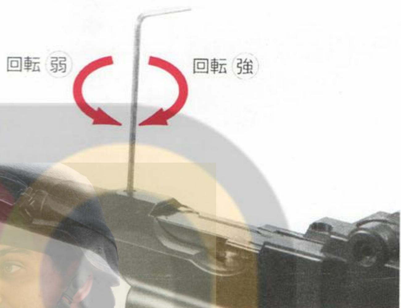
回転 強 強くする側にLD-2アジャストスクリューを回しますと、BB弾に回転が与えられ、飛距離が伸びるようになります。
