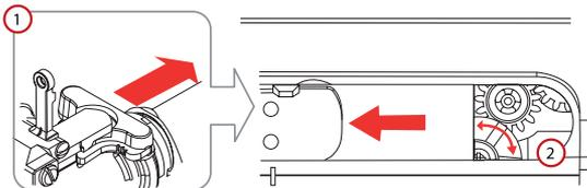
1. Para ajustar el Hop-up, tire la palanca de carga para revelar la palanca de ajuste.
