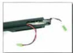
3. Inserte la batería en el tubo de protección.
