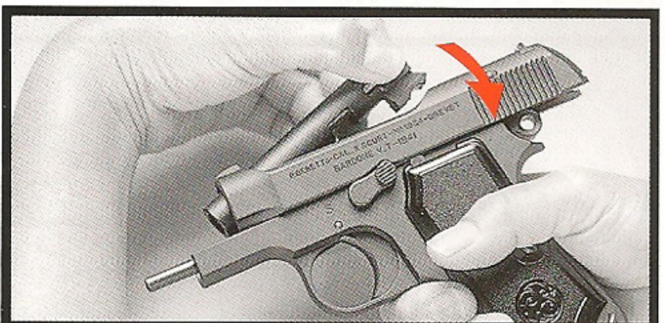
バレル・アッセンブリーは、まずスライド天面くりぬきに斜め後から差し込みます。続いて水平状態にしてから、フレームの内側のレールに合わせ、前方に一杯まで押し込んでください。
