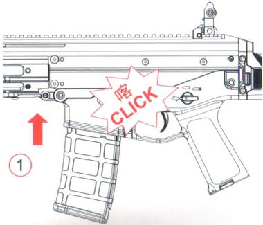
① 正確將彈匣向上插入彈匣口連接牢固直到聽到“喀”一聲。
