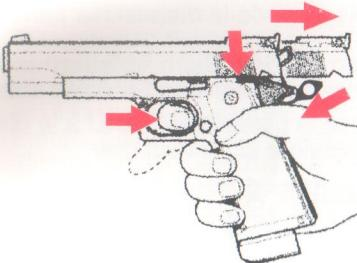
■ 初次裝填彈擊發時需先將滑套後拉使其BB彈上膛，擊扣扳機即可發射
