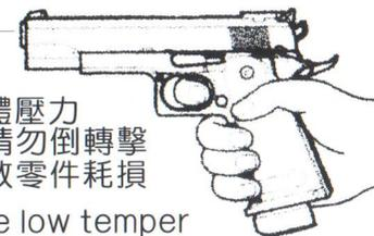
■ 長時間連續發射容易使彈匣過於低溫，影響氣體壓力及子彈初速，此為正常現象非故障所致擊發時請勿倒轉擊發此動作無法使氣體揮發產生霧氣噴出容易導致零件耗損
