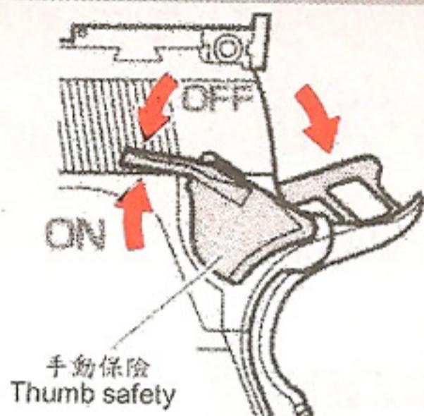
■ 左圖的擊錐只有在「Full Lock」位置時可操作安全裝置在“打開”(ON)的狀態。請勿勉強動作以免破損。
