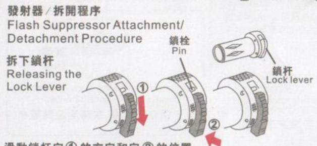
滑動鎖杆向①的方向和向②的位置。 Slide the lock lever towards the① direction and press at position②.
