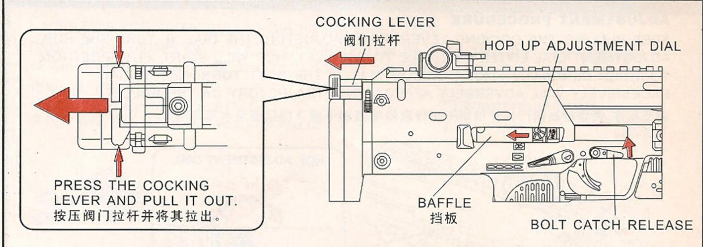
PULL THE COCKING LEVER TO PULL THE BAFFLE RIGHT AND LEFT,
