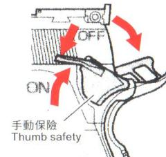
■ 左圖的擊錐只有在「Full Lock」位置時可操作安全裝置在“打開”(ON)的狀態。請勿勉強動作以免破損。
