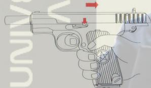
■ 初次裝填彈擊發時需先將滑套後拉使其BB彈上膛，擊扣扳機即可發射
