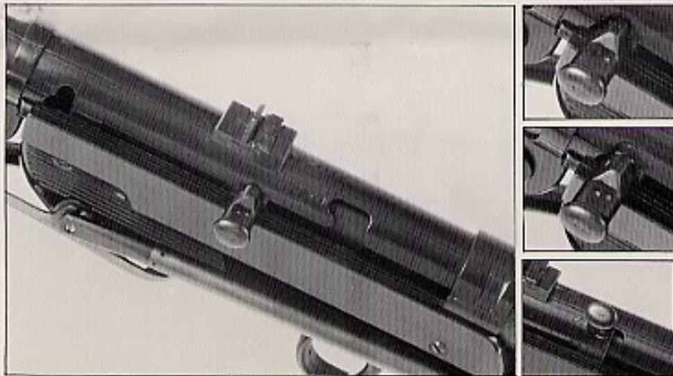
MP40のボルトハンドル部分。写真左は発射位置までハンドルを引いた状態。写真右上はハンドルを押し込んでロックした状態。写真右中は外側に引き出した状態で赤マークが見えます。写真右下はセフティー位置です。
