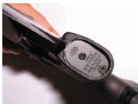
63 鎖上手柄底蓋的十字螺絲後調校中間的機米螺絲。中間的機米位置可調校齒輪及馬達的鬆緊。調校正確，可減少齒輪嘈音及較為耐用。
