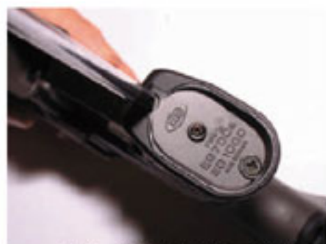
14 拆除手柄底蓋兩粒十字螺絲，中間機米螺絲不要拆。
