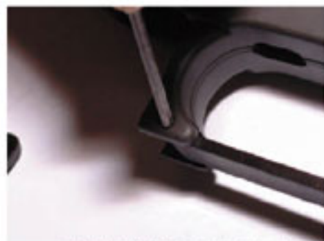
22 取出扳機護片的空心銷，留意取出方向。
