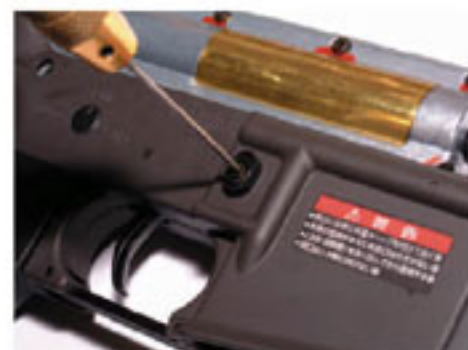
12 拆除彈匣鎖六角螺絲。
