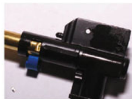
64 槍管裝上上旋膠後，放進上旋座及鎖上固定介子。
