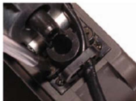
19 拆除上旋座及電線碼共四粒十字螺絲。
