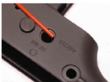
45 適位擦上膠水後，貼上選擇擊鋼片。
