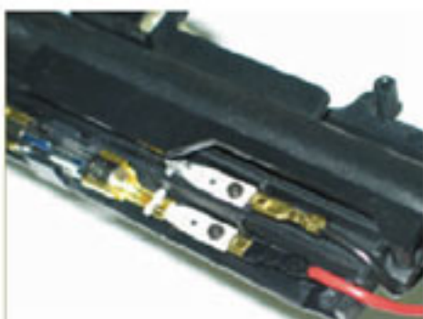
69 電源線裝回 fuse 座。(留意紅黑電源線的位置)
