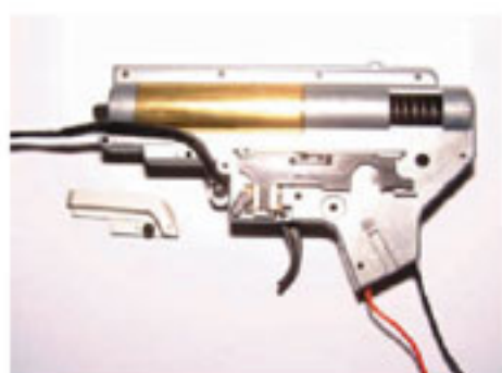
47 拆除波箱前方的電線固定片。
