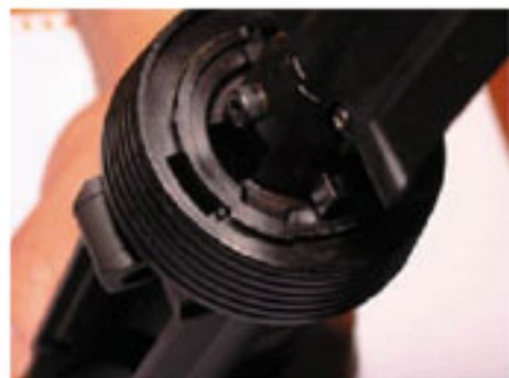
31 將手托的三角圈向左旋轉，可將槍身及前段分離。旋轉時不要把三角圈按下。
