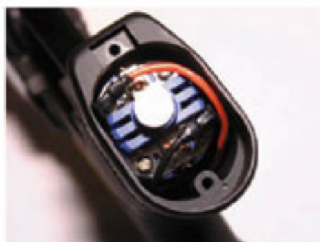
62 放進馬達及金屬片，接駁好電源線。
