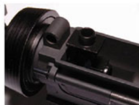
68 檢查槍管及上旋座能否完全放進槍身後，可上下結合。
