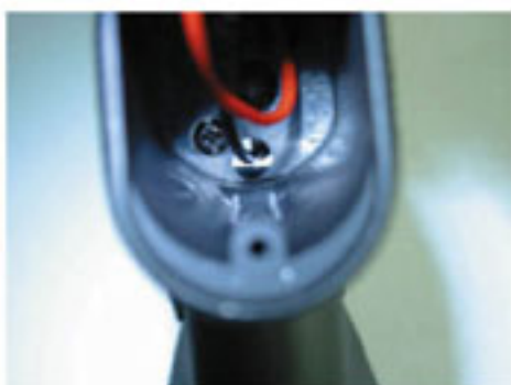
61 把紅黑電源線藏在手柄的電線槽內。如裝得對，馬達向下按時可向上回彈。
