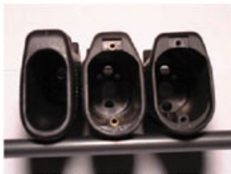
51 G&P 及真槍手柄較為窄，Marui 的較為闊。而 G&P 手柄有金屬絲母固定馬達底蓋，亦較多螺絲孔，可配合強化波箱使用。
