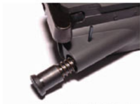
43 Jam Bolt 擊向下按後插入空心銷。(留意 Jam Bolt 擊平面位置)
