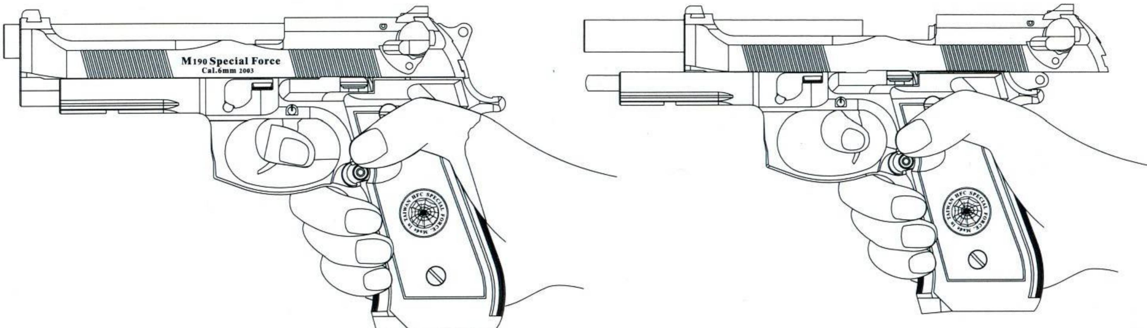
■ 初次裝填彈擊發時需先將滑套後拉使其BB彈上膛，擊扣扳機即可發射
