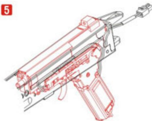
將線材拉到最佳之位置，避免壓到線，並確認電線已裝入BOX中。
