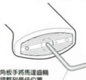
以六角板手將馬達齒輪間隙調整到最佳位置
