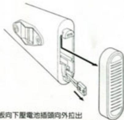
將托底板向下壓電池插頭向外拉出
