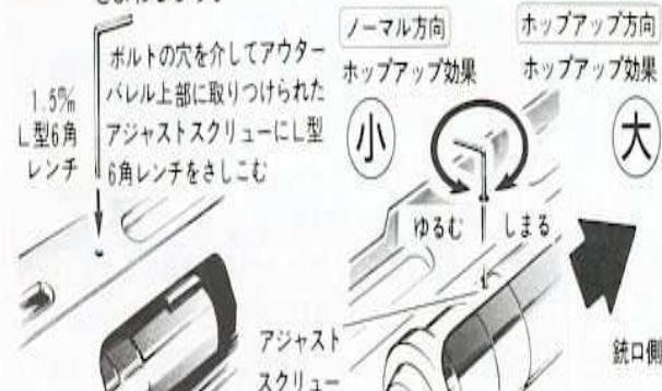
注意: ゆるみすぎるとスクリューの頭部がボルト内壁にこすれ不調になることがあります。ホップ調整後はボルトが正常作動していることを必ず確認してください。
