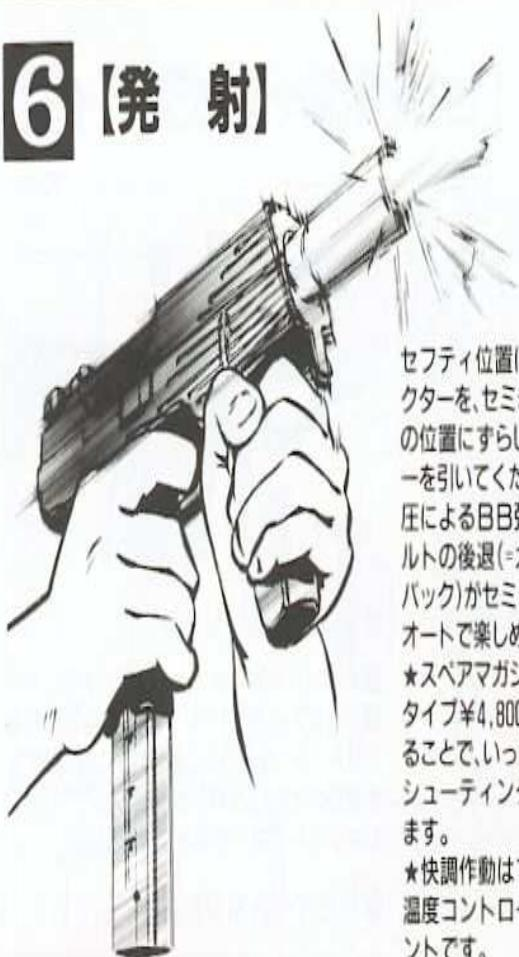
セフェティ位置にあるセレクターを、セミまたはフルの位置にすらして、トリガーを引いてください。ガス圧によるBB弾発射とボルトの後退(=ガスプローブック)がセミまたはフルオートで楽しめます。
