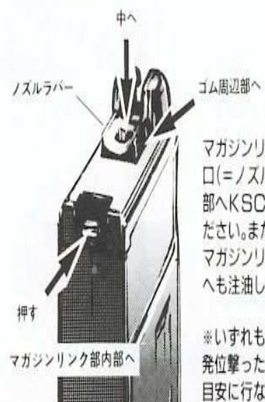
マガジンリンクを押した状態で放出口（＝ノズルラバー）からマガジン内部へKSCガンオイルを注入してください。また、ノズルラバー上面部や、マガジンリンク部のすきまから内部へも注油してください。
