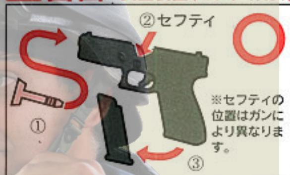
①銃口に保護キャップを装着する。②コッキングされていない事を確かめて安全装置(セフティ)を作動させる。③マガジンを取りはずす。
