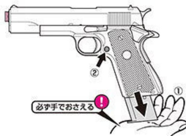
※マガジンキャッチを押すと、マガジンが抜け落ちてきます。
