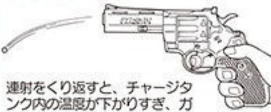
連射をくり返すと、チャージタンク内の温度が下がりすぎ、ガス圧が低下するため、弾の飛びが悪くなりますか故障ではありません。時間を置いてチャージタンクの温度が20°Cくらいまで回復すれば正常に作動するようになります。
