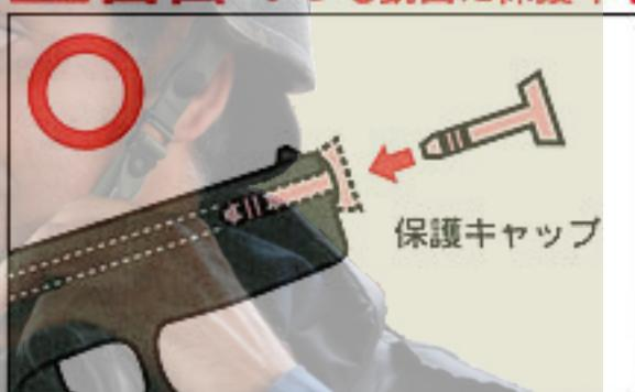
万一の暴発を防ぐと共に、防塵のために発射時以外は必ず銃口に保護キャップを装着して下さい(装着したまま引き金を引かないで下さい)。
