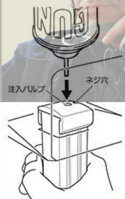
③ マガジンとガスボンベを一直線にして、垂直に持ち、ガスボンベをマガジンにおし付ける。
