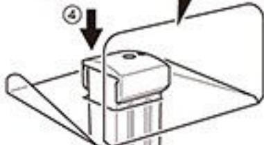
\* 注入カバーの穴に、マガジンを上から差します。「A」の文字がある方に、マガジンのフォロアーが向くようにしてください。
