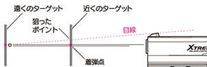
※ターゲットまでの距離が近いと、左図の通りにサイティングしても狙いより下に着弾します。この製品特性上、フロント/リアサイトに着弾点の調節機能はありませんので、着弾点が下がっている場合はターゲットの上を狙うようにしてください。
