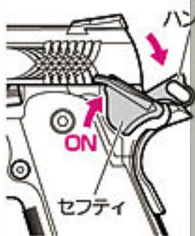
左図のハンマーが「フルコック」位置の時のみ、セフティを操作して、ONの状態に出来ます。また、この状態ではトリガーとスライドが操作できません。破損の原因となりますので、無理に動かさないでください。
