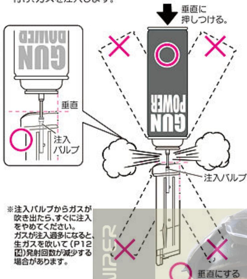
※注入バルブからガスが吹き出たら、すぐに注入をやめてください。ガスが注入過多になると、生ガスを吹いて(P12図)発射回数が減少する場合があります。
