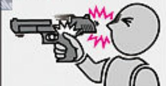
●この製品は、ガスの圧力によりスライドをブローバック(後退)させる、ガスブローバックシステムを搭載したモデルです。スライドが勢いよく立て続けにブローバックしますので、怪我をしないよう、トリガーを引く時は絶対に顔や手をスライドに近づけないでください。
