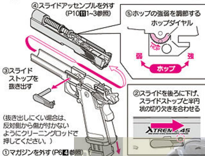
(抜き出しにくい場合は、反対側から傷が付かないようにクリーニングロッドで押してください。)
