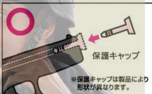
万一の暴発を防ぐと共に、防塵のためにも、発射する時以外は必ず銃口に保護キャップを装着してください。また、保護キャップを装着したままで、トリガーを引かないでください。
