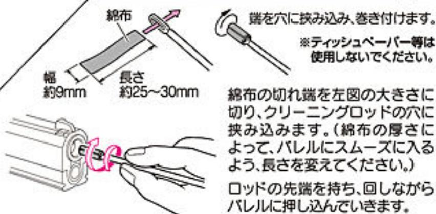
綿布の切れ端を左図の大きさに切り、クリーニングロッドの穴に挟み込みます。(綿布の厚さによって、バレルにスムーズに入るよう、長さを変えてください。) ロッドの先端を持ち、回しながらバレルに押し込んでいきます。
