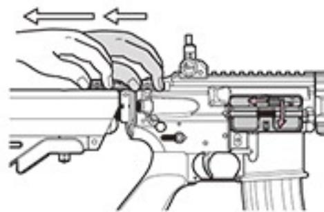
③ ポルトキャッチを押してオートストップを解除します。
