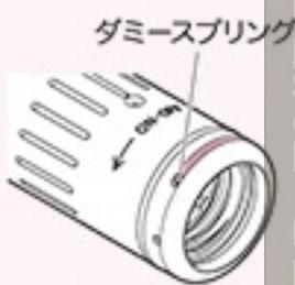
※過大な力で締め付けてしまうと、サイレンサー本体が外れなくなったり、サイレンサー後端パーツが残ってしまう恐れがあります。
