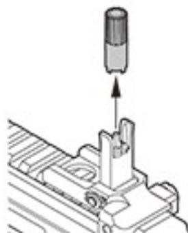
アジャストツールを外してカチッと音がするまで指で回します。
