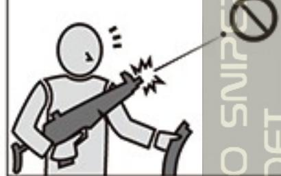
マガジンを抜いても本体にBB弾が残っている場合があり、不用意にトリガーを引くとBB弾が発射され危険です。マガジンを抜いた後、銃口を安全な方向に向けトリガーを引き、BB弾が残っていない事を確認し、銃口に保護キャップを装着して保管してください。
