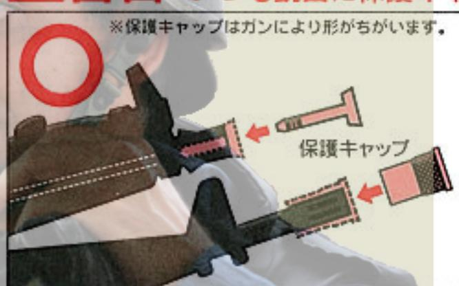
万一の暴発を防ぐと共に、防塵のために発射時以外は必ず銃口に保護キャップを装着して下さい(装着したまま引き金を引かないで下さい)。
