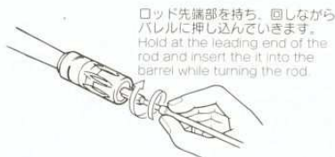
綿布 Cotton cloth 幅 約10mm Width: Approx. 10mm 長さ 約25~30mm Length: Approx. 25~30mm
