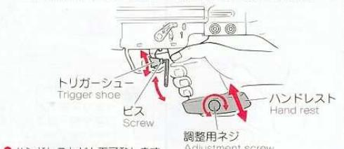
● ハンドレストが上下可動します。調整用ネジを緩め、上・下に位置をずらし、手の下が少し当たる位に調整するとよいでしょう。調整後、調整用ネジを締めます。
