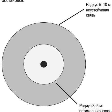
Радиус действия радиостанции достигает 10 метров. В пределах данного радиуса радиосвязь в полнодуплексном режиме могут поддерживать до четырех пользователей.
