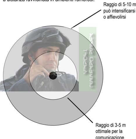
Il raggio massimo di comunicazione senza fili mediante tecnologia NIB è di 10 m. All'interno di questo perimetro è possibile la comunicazione duplex tra un massimo di quattro persone.
