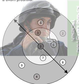
U bučnim okruženjima, jednostavno govorite blizu osobe sa kojom želite da razgovarate. NIB tehnologija će se postepeno aktivirati i deaktivirati (u prečniku od 5 do 10 m) i omogućiti komunikaciju sa osobama u blizini. Ostanite u okviru prečnika od 3 do 5 m radi optimalnog signala komunikacije.
