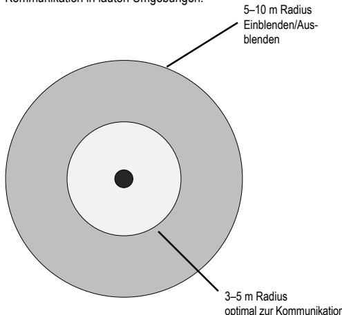
Die NIB-Technologie ermöglicht die kabellose Kommunikation innerhalb eines Radius von 10 m. Full-Duplex-Kommunikation für bis zu vier Personen innerhalb dieses Bereichs.
