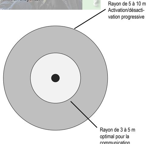
La technologie NIB permet une communication sans fil dans un rayon de 10 m. Communication en duplex intégral pour un maximum de quatre personnes dans ce périmètre.
